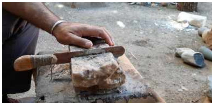
Рисунок 4.3. Экспериментальное выпиливание каменной заготовки для колонки
