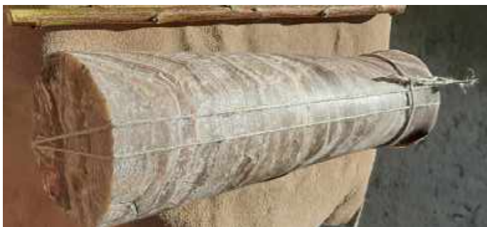
Рисунок 4.27. Приспособление для разметки желоба.
